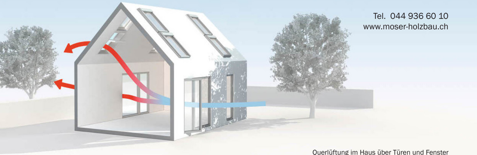
Querlüftung im Haus über Türen und Fenster
